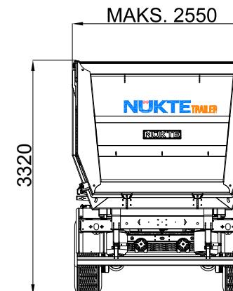
BENNE BASCULANTE À CUVE
